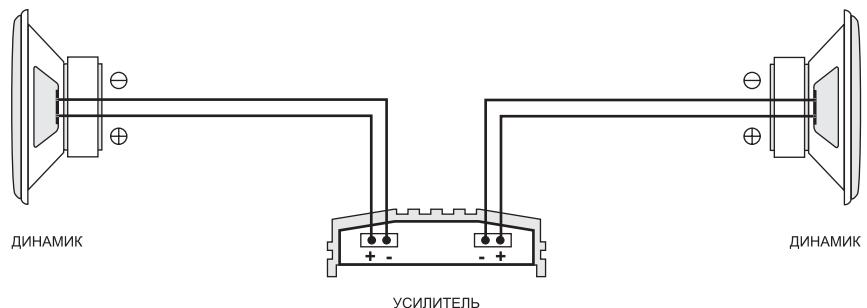
B) Схема подключения компонентных динамиков.
