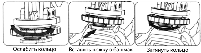
Ослабить кольцо Вставить ножку в башмак Затянуть кольцо
