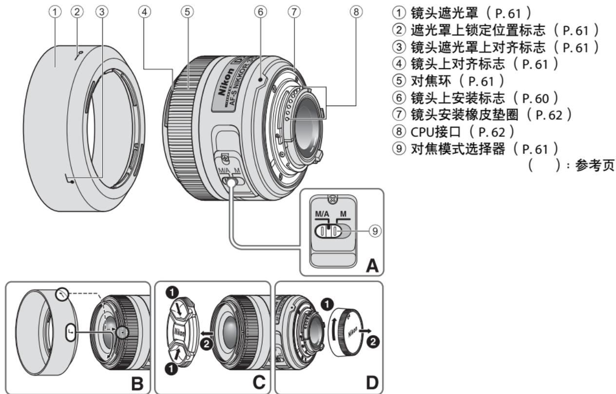
感谢您购买AF-S DX 尼克尔 35mm f/1.8G镜头。DX 尼克尔镜头是配合D300和D90等尼康DX格式数码单反相机使用的专用镜头。如果安装在尼康DX格式相机上，则镜头画角相当于35mm格式相机的1.5倍焦距的画角。使用本镜头之前，请先阅读这些说明并参阅相机的*用户手册*。
