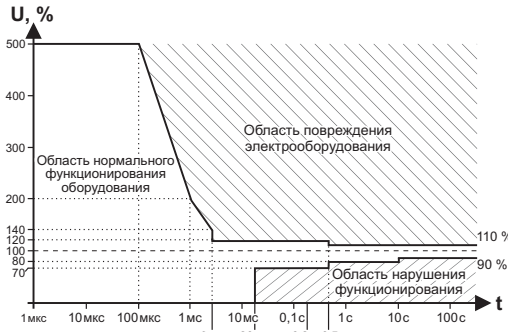
Рис. 1. Кривая работы электрооборудования ITIC (CBEMA), ( http://www.home.agilent.com/upload/cmc_upload/All/1.pdf?&cc=UA&lc=eng ).
